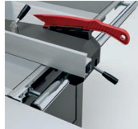
■ **Продольный упор:** Продольный упор отличается лёгкостью хода и точностью регулировки. Лёгкость хода упора обеспечивается твёрдохромированной штангой круглого сечения. При раскрое крупногабаритных плит упор может быть при помощи рукоятки опущен ниже уровня стола.
