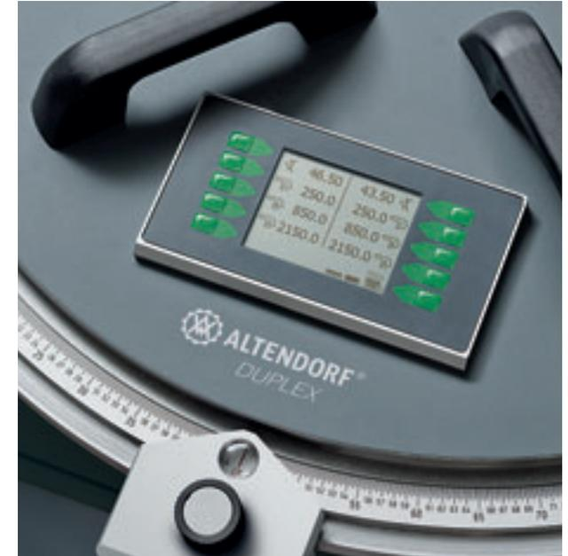
■ **DUPLEX DD:** Упор этой модификации запатентован как изобретение фирмы Altendorf во многих странах. Он обеспечивает дополнительные удобства оператору и помогает избежать потерь времени на подсчёты, замеры, пробные пропилы. Упор снабжён электронным устройством, которое вычисляет длину раскроя с учётом углов по обе стороны от упора и выдаёт на табло цифровое отображение обоих значений.
