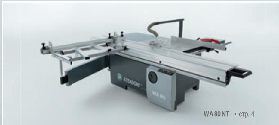
*Altendorf WA 80 NT с ручной настройкой высоты основного пильного диска, не наклоняемый.*
