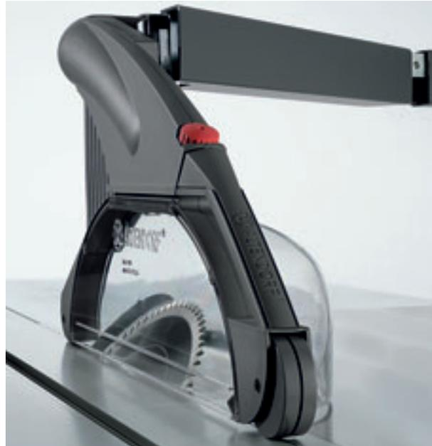
■ **Защитный колпак:** Защитный колпак „Altendorf“ впечатляет своей продуманной конструкцией, обеспечивающей оптимальную вытяжку. Всего лишь нескольких движений руки достаточно для того, чтобы заменить широкий колпак на узкий. Колпак позволяет производить распиловку с максимальной высотой пропила 125 мм (независимо от подрезного агрегата) и может быть полностью отведён в сторону. Опционально для WA 80 NT и WA 80 T.
