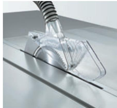
■ **Защитно-вытяжной колпак:** Малый колпак для пильного диска, диаметром 315 мм и высотой пропила макс. 82 мм, крепится на расклинивающем ноже.
