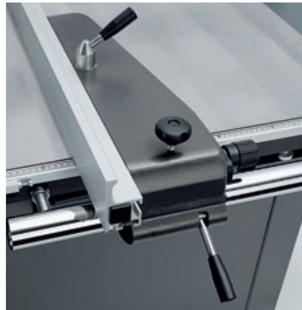
■ **Продольный упор с ручной тонкой настройкой:** Ручная тонкая настройка облегчает точную установку продольного упора. Регулировочный винт обеспечивает юстировку упора с точностью до миллиметра.
