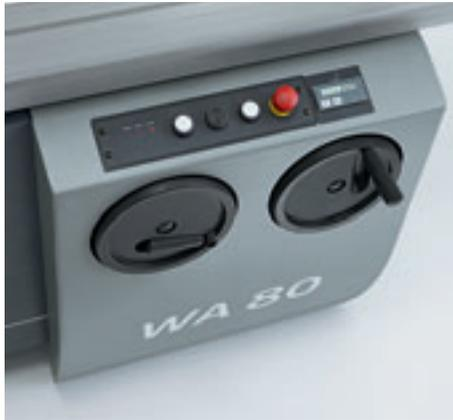
■ **Панель управления на станине станка:** Панель управления, размещённая на станине станка имеет показания угла наклона. Настройка высоты и угла наклона основного пильного диска вручную, посредством маховичка.
