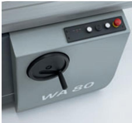
■ **Панель управления на станине станка:** Размещённая на станине станка панель управления обеспечивает хороший обзор всех функциональных элементов. Настройка высоты основного пильного диска вручную, посредством маховичка.
