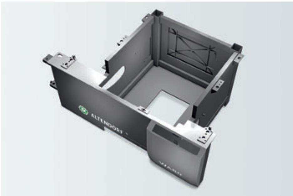
■ **Устойчивость и жёсткость к скручиванию:** Жесткая станина WA 80 соответствует по своей конструкции станинам станков серии F 45. Рамная конструкция обеспечивает ровный ход всех механизмов и высокую устойчивость станка. Станина полностью закрыта.
