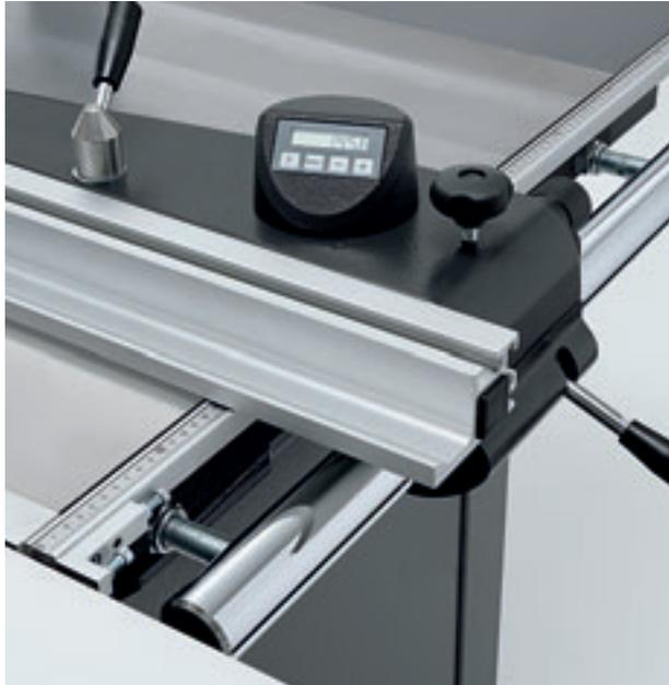
■ **DIGIT X:** Цифровая индикация размеров по ширине раскроя для продольного упора с тонкой ручной настройкой. Данная электронная измерительная система гарантирует точную и быструю настройку продольного упора. Повторяемые параметры могут в точности воспроизводиться и считываться на дисплее системы DIGIT X. Система не подвержена износу и не чувствительна к пыли. При перестановке упорной линейки из положения плашмя на ребро или наоборот производится автоматическая корректировка размеров.
